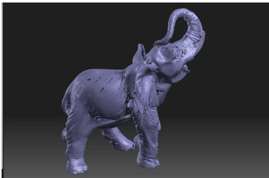
Рис. 2. Неполные участки на отсканированной модели
