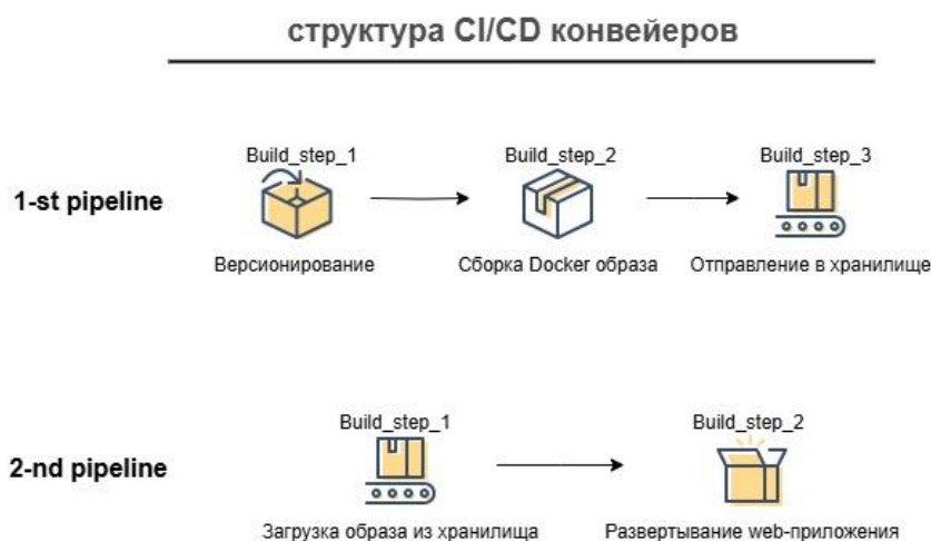
Рис. 1. Последовательность шагов сборки в двух конвейерах
